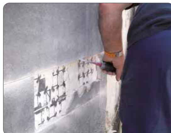
Immagini di prove di resistenza al fuoco in facciata su una parete di 3x3 mt isolata con sistema spideREX K8, sottoposta all'azione di un bruciatore da 300 KW per la durata di 10 minuti.
