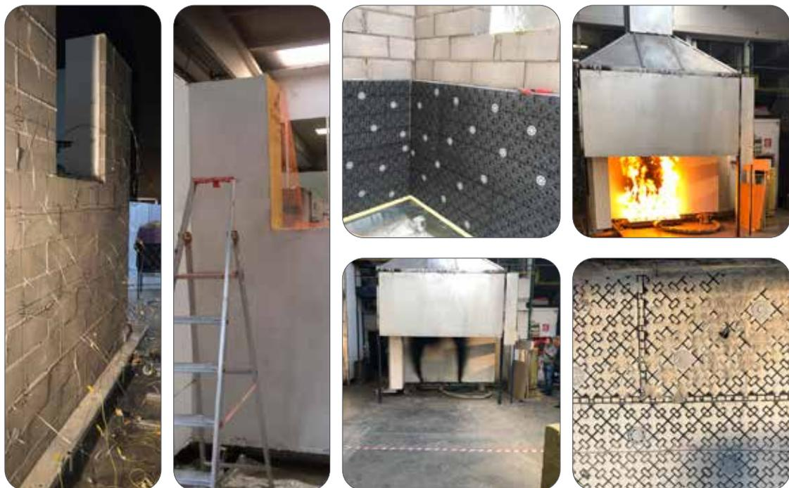
Test svolti in conformità alla norma UNI EN 13501-1:2009, classificazione al fuoco dei prodotti e degli elementi da costruzione.
