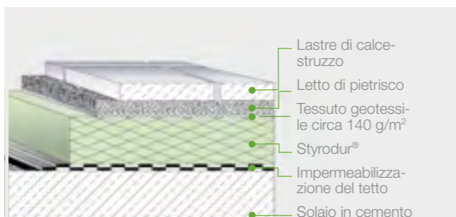
Fig. 38: Struttura di un tetto rovescio a terrazza con lastre in calcestruzzo su letto di pietrisco.
