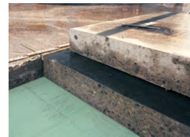
Fig. 52: Lastra della carreggiata in calcestruzzo gettato in opera per lo studio scientifico del comportamento nel lungo periodo.
