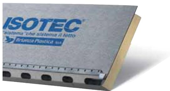
Isotec è un sistema di isolamento termico in poliuretano espanso rigido, studiato per tutti i tipi di tetto. Questo semplice sistema prevede la posa di pannelli strutturali componibili, leggeri, con bordi longitudinali e di testata, conformati a battenti ed incastri contrapposti che realizzano rapidamente un impalcato portante, termoisolante, microventilato ed impermeabile alle infiltrazioni accidentali del manto di copertura.
