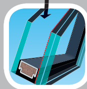
Vetro di sicurezza L3 - vetrocamera 4HS-14-33.1T con vetro interno laminato basso emissivo e vetro esterno temperato con pellicola autopulente Activ. Riempito con gas nobile Argon. Telaio distanziale Warm Edge TGI.
